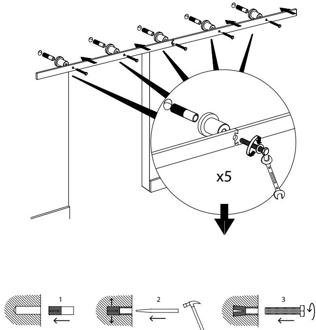
**-2B-** Montage op houten muur - Wand aus Holz - Wooden wall
