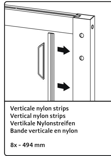
Tip: Monteer de nylon strips aan de muurzijde van de deur voor een stijlvol resultaat. Gebruik voor montage van de strips het meegeleverde gereedschap en een beetje zeep. Knip de strips indien nodig op maat.
